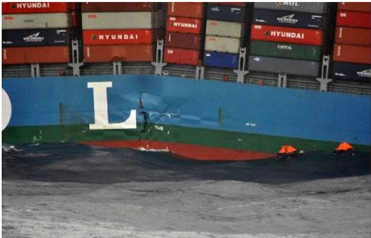
Selon les quelques photos prises au moment de l'accident, il semblerait que la brèche soit dûe à de gros efforts d'arc subis par la coque. On constate en tous cas une cassure nette sur toute la largeur et la hauteur de la coque. Il est encore difficile de dire s'il s'agit d'une défaillance structurelle du navire ou si l'accident est imputable à une mauvaise répartition de la cargaison, qui aurait eu pour conséquence une mauvaise répartition des efforts.
